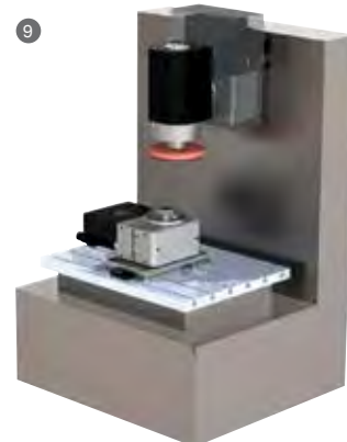
9 4° eje para girar el husillo del husillo portamuelas. 5° eje (vertical) para rotación de pieza
