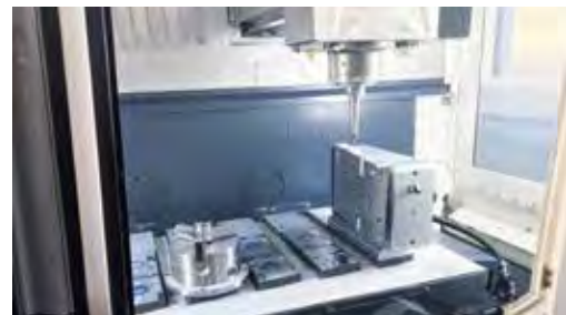
Aplicación de un 4° eje en un centro de procesamiento de 3 ejes
