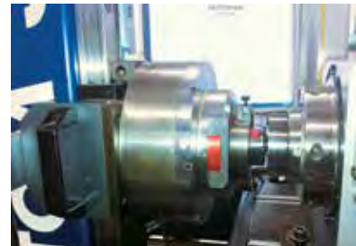
Medición de la precisión del indexado - completamente automática
