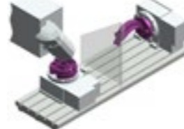
Mecanizado con divisor de utilización vertical/horizontal sobrepuesto sobre la mesa de trabajo.
