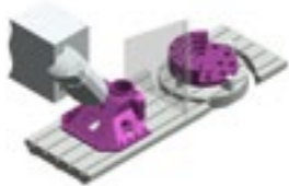
Mecanizado en trabajo pendular con divisor de eje vertical integrado.
