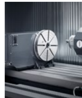
Divisor de sobremesa con posibilidad de utilización horizontal y vertical.
