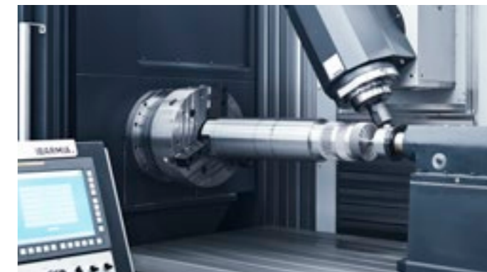
Plato de torneado de eje horizontal integrado en la máquina.
