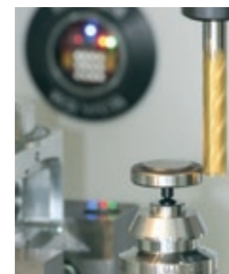
Calibración automática de herramientas en longitud y radio mediante palpación (ubicación del palpador necesariamente en el área de trabajo).
