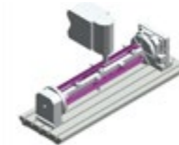
Mecanizado de piezas sobre placa ó cubo giratorios mediante divisor de eje horizontal y soporte de apoyo.
