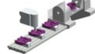
Mecanizado en trabajo pendular con mesa fija en una de las zonas de trabajo y en el otro lado un divisor de dos ejes integrado en la bancada.
