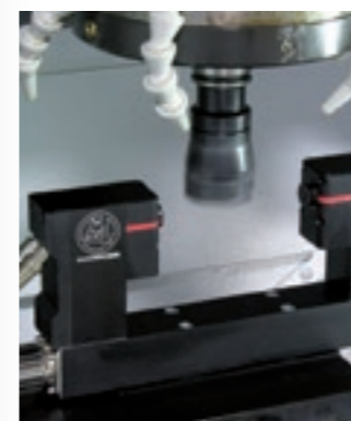
Emisor/receptor sobre soporte fijo (debe ubicarse dentro del área de mecanizado)
