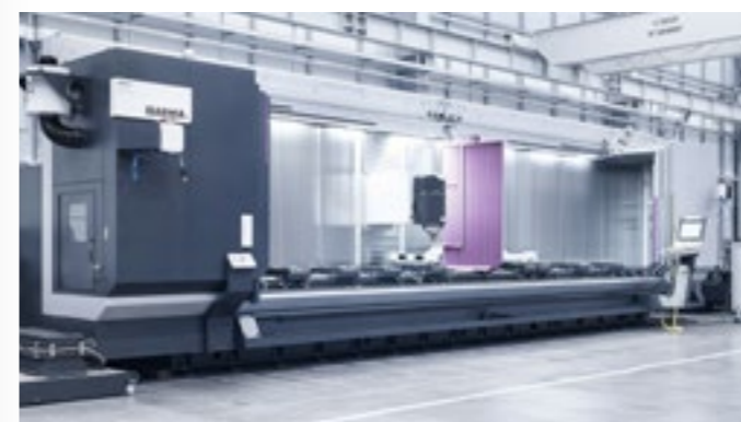
Máquina extralarga, con recorridos en X que pueden alcanzar los 12 m. Ideal para piezas tipo larguero del sector aeronáutico.
