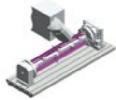
Mecanizado de piezas sobre placa ó cubo giratorios mediante divisor de eje horizontal y soporte de apoyo.
