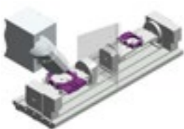
Mecanizado en trabajo pendular con un divisor de eje horizontal a cada lado.
