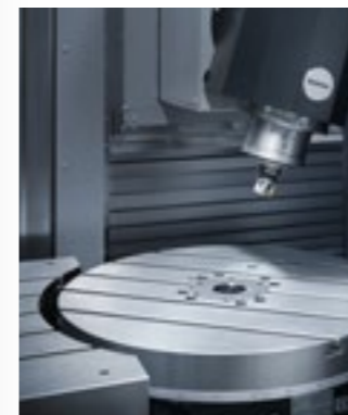
Divisor de eje vertical integrado en la bancada.
