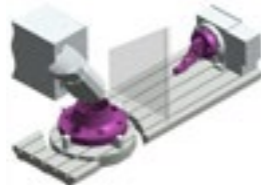
Mecanizado en trabajo pendular con divisor de eje vertical integrado y otro de eje horizontal en la otra zona de trabajo.
